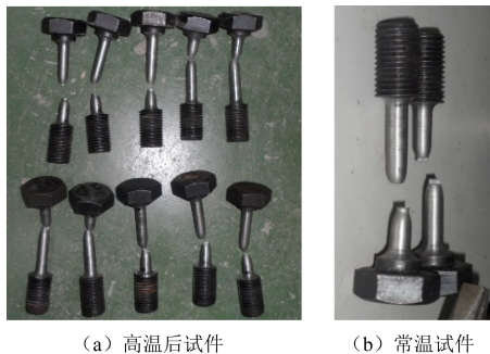
图4 试件破坏状态
